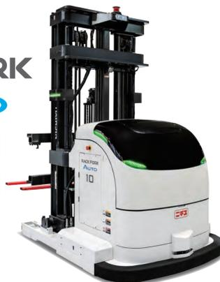
高層ラックでの入出庫を自動化。最小通路幅で3方向荷役が可能。
