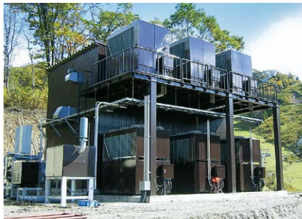
ホワイトピア高鷲 (セミプラント型人工造雪装置SPP180 製氷能力180t/日)
