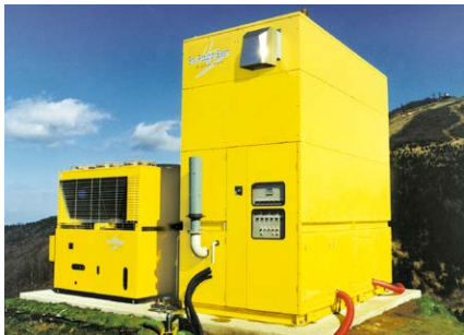
ユートピアサイオト (ユニット型人工造雪装置SPS60 製氷能力60t/日)
