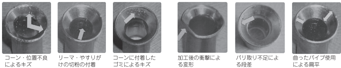
図2 フレア加工の不具合例
