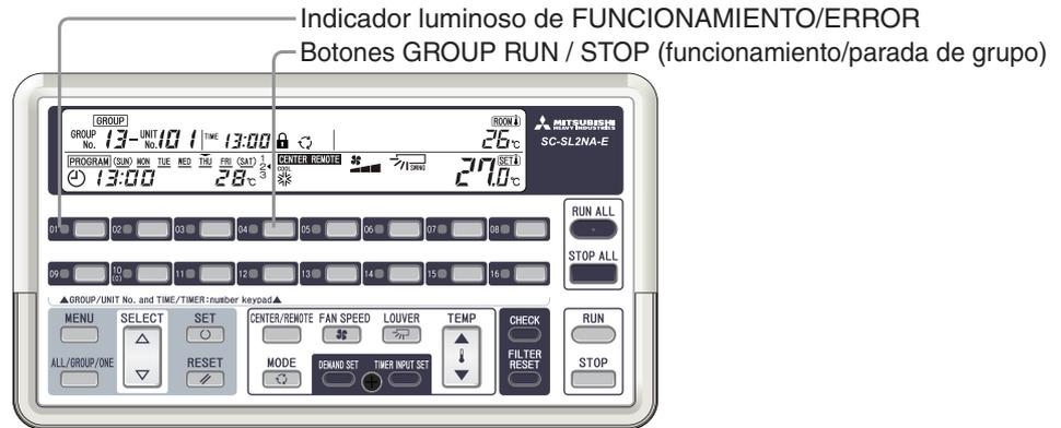
**<FUNCIONAMIENTO>** Con los acondicionadores de aire parados (área RUN/ERROR (funcionamiento/error) desactivada), pulse un botón GROUP RUN / STOP (funcionamiento/parada de grupo).
