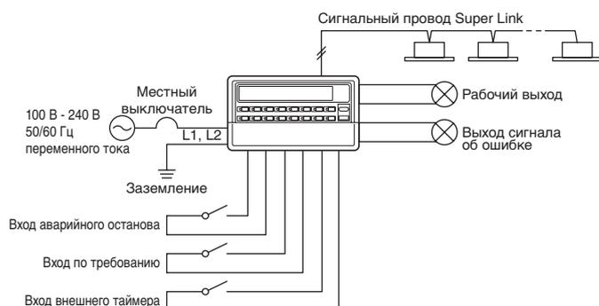
Прежде чем подключать провода, снимите крышку с блока терминалов. После завершения работ поставьте крышку блока терминалов на место. Крышка предназначена для защиты от поражения электрическим током при случайном прикосновении.
