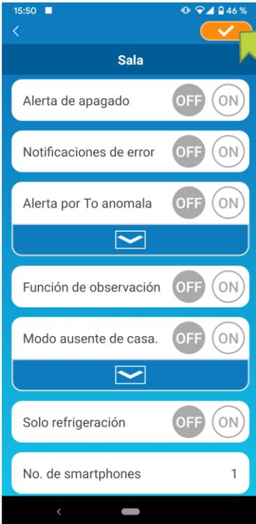
Cambie entre [ON] y [OFF] y pulse
