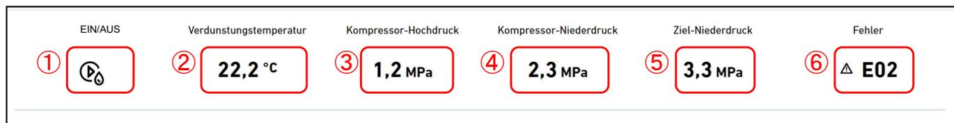
Auf diesem Bildschirm werden die folgenden Elemente im Zusammenhang mit der Hyozan-Einheit angezeigt.
