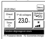
Si du givre se forme sur l'unité extérieure, ses performances de chauffage se dégradent. La fonction dégivrage du module hydraulique se déclenche automatiquement, et l'eau chaude de l'unité intérieure s'arrêtera. Le message "Dégivrage en cours" s'affiche à l'emplacement du message. Une fois le dégivrage terminé, le message "Dégivrage en cours" disparaît, et l'unité repasse en mode chauffage normal.
