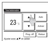
9 Sélectionner la température souhaitée (par intervalles de 1 °C) à l'aide des touches ▲ ▼. Ou appuyer sur la touche [Auto] et sélectionner le réglage automatique de la température.
