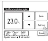
**4 L'appui sur la touche [Activer] de l'écran de paramétrage de chaque fonction permet l'enregistrement du réglage.**
