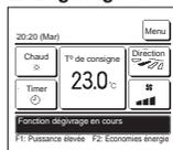
Si du givre se forme sur l'unité extérieure, ses performances de chauffage se dégradent. La fonction dégivrage du module hydraulique se déclenchera automatiquement, et l'eau chaude de l'unité intérieure s'arrêtera. Le message "Dégivrage en cours" s'affiche à l'emplacement du message. Une fois le dégivrage terminé, le message "Dégivrage en cours" disparaît, et l'unité repasse en mode chauffage normal.
