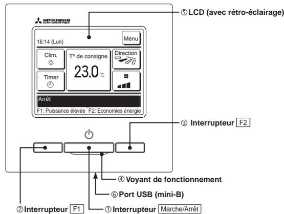
L'écran tactile, activé par une pression du doigt sur l'écran LCD, est utilisé pour toutes les fonctions à l'exception de celles assurées par les interrupteurs ① Marche/Arrêt, ② F1 et ③ F2.
