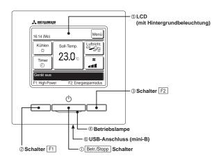
Das Touchscreen-System wird durch Berühren des LCD-Displays mit dem Finger bedient. Über den Touchscreen werden alle Bedienschritte ausgeführt, die nicht mit ① "Betr./Stopp" und den Schaltern ② F1 und ③ F2 ausgeführt werden können.
