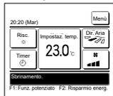
Quando si forma brina nella U/E, le prestazioni di riscaldamento si riducono. In questo caso l'unità passa automaticamente all'operazione di sbrinamento e l'acqua calda dall'U/E si arresta. Nello schermo messaggi compare il messaggio "Sbrinamento". Dopo il completamento del funzionamento in sbrinamento, il messaggio "Sbrinamento" scompare, e l'unità torna al suo normale funzionamento in riscaldamento.
