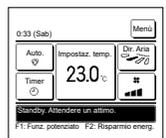
È possibile che compaia il messaggio "Standby. Attendere un attimo." (per un massimo di 30 minuti) sul telecomando al primo utilizzo in seguito all'accensione o all'interruzione dell'alimentazione. Ciò non indica un guasto; è causato dal controllo di protezione dell'olio della macchina di raffreddamento, che viene attivato per proteggere il compressore. Attendere che il messaggio "Standby. Attendere un attimo." scompaia.
