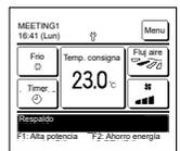
Cuando se produce un error en la U/E pero el funcionamiento continúa como medida de emergencia, se muestra el mensaje "Respaldó". Cuando se muestre "Respaldó", contacte de inmediato con el distribuidor o la empresa que figure como empresa de contacto para que la unidad sea inspeccionada.
