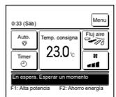
El mensaje "En espera. Esperar un momento" puede mostrarse (como máximo, 30 minutos) en el mando a distancia durante la primera operación tras activar un disyuntor o después de un fallo eléctrico. Esto no indica ningún problema; se debe a la activación del control de protección del aceite de refrigeración de la máquina, que sirve para proteger el compresor. Espere a que el mensaje "En espera. Esperar un momento" desaparezca.
