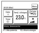
Quando se forma hielo en la U/E, el rendimiento de la calefacción disminuye. Esto hará que la unidad cambie automáticamente al modo de desescarche y el agua caliente del IO se detendrá. Aparecerá el mensaje "Ahora, desescarche." en la pantalla. Tras completar la operación de desescarche, desaparecerá el mensaje "Ahora, desescarche." y la unidad volverá a funcionar en el modo normal de calefacción.
