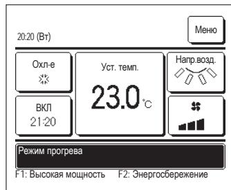
В случае выбора включения прогрева с помощью таймера ВКЛ через промежуток времени (☞ стр. 18) или таймера ВКЛ по часам (☞ стр. 19), работа начнется на 50 - 60 минут раньше, что прогнозируется, исходя из предыдущей операции прогрева, поэтому к моменту достижения времени начала работы температура в помещении будет приближаться к заданной температуре.
