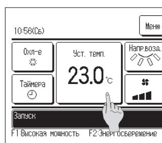
1 Нажмите кнопку **Установка температуры** на ОСНОВНОМ экране.
