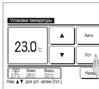
4 Когда на экране настроек для каждого пункта отображается кнопка **Уст.**, при нажатии на нее настройка подтверждается.
