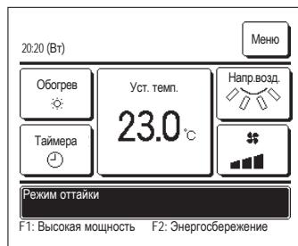
В случае образования инея на наружном агрегате эффективность обогрева снижается. Это приведет к автоматическому переключению устройства на режим оттаивания, и горячий воздух перестанет выдуваться из IO. На дисплее сообщений появится сообщение «Режим оттайки». По завершения оттаивания сообщение «Режим оттайки» исчезнет, и устройство снова переключится на нормальный обогрев.
