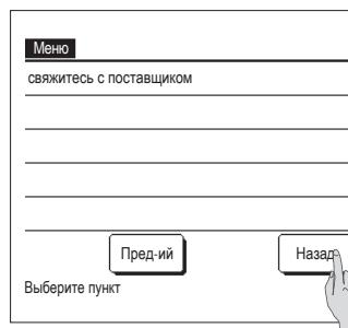
3 При нажатии кнопки **Назад** дисплей возвращается к ОСНОВНОМУ экрану.
