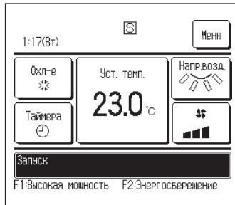
Когда один ИУ управляется с двух блоков ПДУ, то на вспомогательном блоке ПДУ нельзя выполнить следующие настройки. Необходимо использовать основной блок ПДУ. В случае попытки установить настройки на вспомогательном ПДУ на экране отображается пиктограмма **S**.
