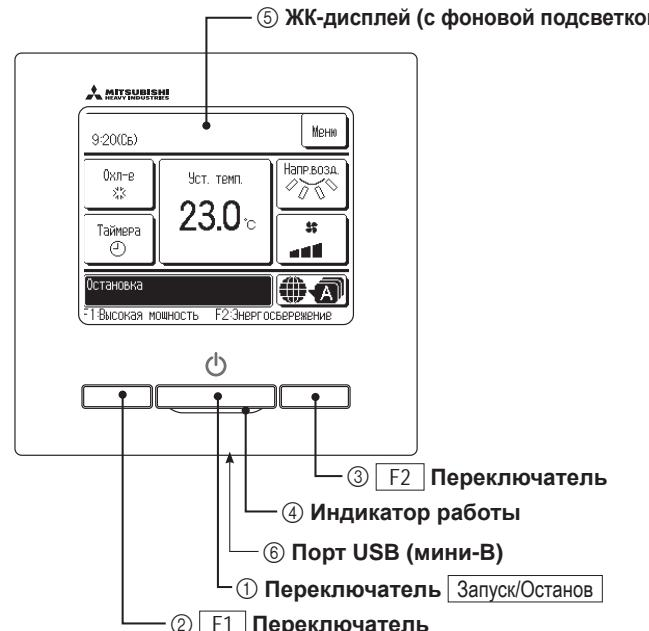
Система с сенсорной панелью, срабатывающая при касании пальцем ЖК-дисплея, применяется для любых действий, кроме ① Run/Stop (пуск/стоп), ② переключатели F1 ③ F2.
