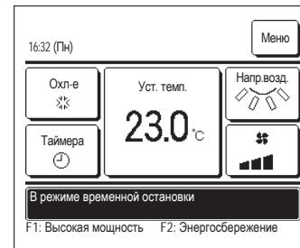
Эти сообщения будут отображаться, если управление агрегатом осуществляется с помощью внешнего входа IO. Сообщение не указывает на неисправность, а указывает на то, что агрегат управляется с помощью внешнего входа IO.
