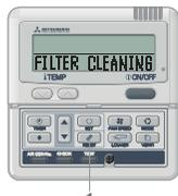
Отображается "FILTER CLEANING" Когда совокупное время работы достигает установленного предельного числа часов, чтобы напомнить о том, что пора почистить фильтр.
