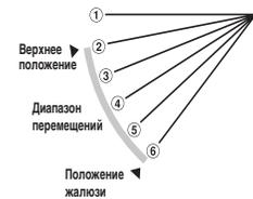
Примечание : Если номера верхнего и нижнего положения совпадают, то жалюзи фиксируются в этом положении. Функция автоматического качивания не работает.
