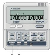
1 Presione el botón AIR CON No. Se muestra el modo de indicación del n.º del aire acondicionado.
