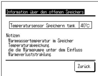
3. Erfolgt die Kommunikation mit der Wärmepumpeneinheit, wird die Erkennungstemperatur des Temperatursensors des offenen Speichers angezeigt.
