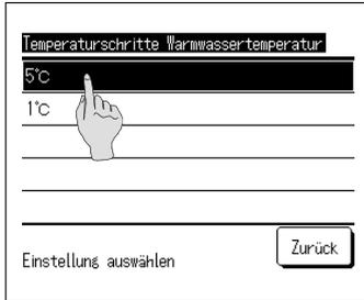
1. Durch Antippen von [Temperaturschritte Warmwassertemperatur] (Step size of HW temp) im Menübildschirm [Administratoreinstellungen] (Administrator settings) wird der Menübildschirm [Temperaturschritte Warmwassertemperatur] (Step size of HW temp) angezeigt.
