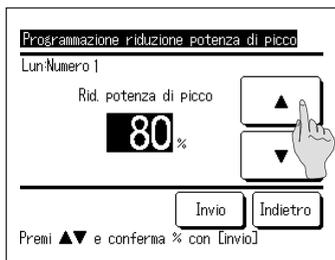
10. Impostare la [% Riduzione potenza di picco]. Impostare la [% Riduzione potenza di picco] premendo i pulsanti ▲ ▼. La [% Riduzione potenza di picco] si può impostare al 10%, 40%, 60% e 80%.
