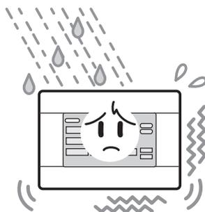
Если устройство установлено там, где оно подвергается воздействию влаги, брызг воды или сильной вибрации, это приведет к неисправной работе.
