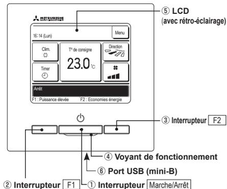
L'écran tactile, activé par une pression du doigt sur l'écran LCD, est utilisé pour toutes les fonctions à l'exception de celles assurées par les interrupteurs ① Marche/Arrêt, ② F1 et ③ F2.
