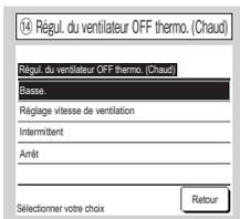
Choisir la vitesse de ventilation lors de la régulation en mode chauffage.
