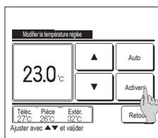
4 L'appui sur la touche de l'écran de paramétrage de chaque fonction permet l'enregistrement du réglage.
