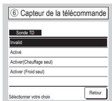
Vous pouvez modifier le capteur de température de reprise d'air de l'UI maître sur le côté de la télécommande.
