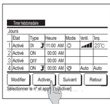
12 Ouvrir l'écran de contrôle des réglages. Pour enregistrer le réglage, appuyer sur la touche **Activer**.
