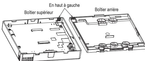
② Fixer le boîtier arrière de la téc sur une surface plane avec les deux vis à bois.
