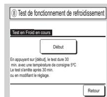
Cette fonction peut être effectuée lorsque le refroidissement est à l'arrêt. Si la température ambiante est trop basse pour activer le test de fonctionnement de refroidissement, la température de consigne sera fixée à 5 °C pendant 30 minutes.
