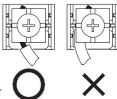
En cas de passage des câbles en haut au centre, ouvrir un passage avant de séparer les boîtiers supérieur et arrière. Cela réduira le risque d'endommagement de la platine de contrôle et simplifiera la tâche.
