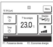
Si une unité intérieure est contrôlée à l'aide de 2 télécommandes, les paramètres suivants ne peuvent pas être réglés via la télécommande secondaire. La télécommande principale devra être utilisée. L'icône s'affiche sur l'écran de la télécommande secondaire.
