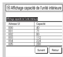
Les capacités des UI connectées à la tél. s'affichent. Lorsque sept unités ou plus sont connectées, appuyez sur le bouton **[Suivant]** pour tout afficher. Ces éléments peuvent ne pas s'afficher en fonction de la combinaison des UI et des UE affichées.
