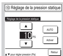
Ce réglage est possible si l'UI de type gainable équipée est connectée à la fonction de réglage de la pression statique externe. Sélectionner la pression statique externe et appuyez sur le bouton .
