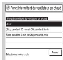
Sélectionner le mode de contrôle de la ventilation après le fonctionnement résiduel de la ventilation en régulation et après l'arrêt en mode chauffage.
