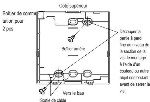
③ Raccorder les câbles entre les bornes X et Y de la télécommande et les bornes X et Y de l'unité intérieure. Raccordement sans polarité. Fixer les câbles de façon à ce qu'ils s'enroulent autour des vis de la borne sur la partie supérieure du boîtier de la téc.
