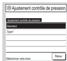
Le contrôle de pression doit être réglé lors de la connexion de climatiseurs extérieurs au système Multi (KX).
