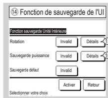
Dans le cas des modèles de série Multi (KX), il est possible d'imposer que les unités esclaves intérieures aient le même mode de fonctionnement (chauffage, refroidissement) que l'unité maître intérieure. Régler l'adresse de l'UI maître sur les UI esclaves. Les UI esclaves sur lesquelles est réglée l'adresse de l'UI maître suivent les réglages de l'UI maître.
