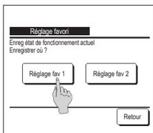
1 Sur l'écran de démarrage, régler le mode de fonctionnement, la température de consigne, la vitesse et le sens de ventilation.
