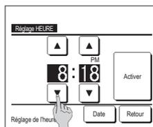
3 Régler l'heure "heure : minute" à l'aide des touches **▲** **▼** sur l'écran de réglage de l'horloge. Appuyer sur la touche **Activer** pour valider le réglage. Pour modifier "jj/mm/aa", appuyer sur la touche **Date**.
