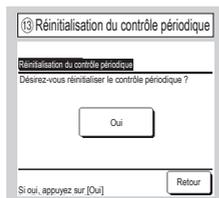
Le compteur horaire est réinitialisé en réinitialisant le contrôle périodique.
