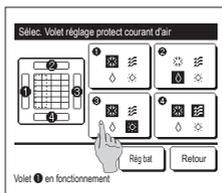
3 Sélectionner le numéro de la sortie d'air au niveau de laquelle le panneau anti courant d'air doit être réglé.
