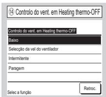
Configura a velocidade de ventilação durante arrefecimento termo-OFF.
