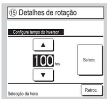
Em função de rotação de UI, é configurado o temporizador de alternância para o funcionamento de 2 unidades interiores. O temporizador pode ser configurado dentro de um intervalo de 10 a 990 horas em incrementos de dez horas.
