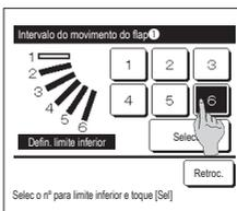
5 Seleccione uma das posições limite inferiores de 1 para 6 para o intervalo de movimento do deflector. O intervalo de movimento entre as posições limite superiores e inferiores é exibido a preto. Depois de seleccionar o intervalo, toque no botão **Selec.**
