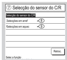
Pode ajustar a temperatura de detecção do sensor do C/R.
