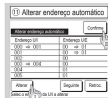
No caso dos modelos Multi series (KX), os endereços UI registados com o método de configuração auto-endereço podem ser alteradas com esta função.
