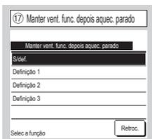
Selecciona o tempo de funcionamento residual de ventilação depois da paragem e termo-OFF em modo de aquecimento.
