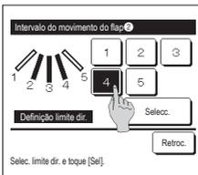
9 Seleccione uma das posições limite direitas de 1 para 5 para o intervalo de movimento do deflector. O intervalo de movimento entre as posições limite esquerdas e direitas é exibido a preto. Depois de seleccionar o intervalo, toque no botão **Selec.**
