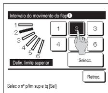
4 Seleccione uma das posições limite superiores de 1 para 6 para o intervalo de movimento do deflector. Depois de seleccionar o intervalo, toque no botão **Selec.**
