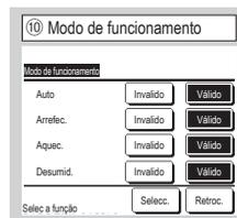
**Válido** ou **Invalido** pode ser definido para cada modo de funcionamento. Se o arrefecimento ou aquecimento for desactivado, o auto também é desactivado.
