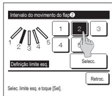
8 Seleccione uma das posições limite esquerdas de 1 para 5 para o intervalo de movimento do deflector. Depois de seleccionar o intervalo, toque no botão **Selec.**
