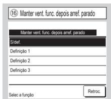
Selecciona o tempo de funcionamento residual de ventilação depois da paragem e termo-OFF em modo de arrefecimento.
