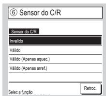
Pode alterar o sensor de temperatura de ar recirculado da unidade principal UI para o lado do C/R.
