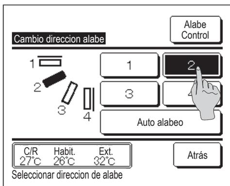
2 Cuando aparezca la pantalla de cambio de dirección del álabes, pulse el botón
