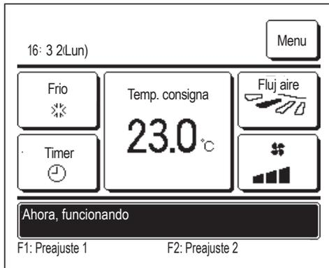
**1** Al pulsar el botón **F1** (**F2**) se habilitarán el modo de operación, la temperatura, la velocidad del ventilador, la dirección de los álabes registrados en Preajuste 1 o Preajuste 2.
