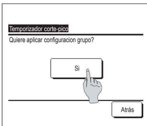
13 Se abre una pantalla que muestra la configuración de grupo. Toque el botón  para guardar la configuración.
