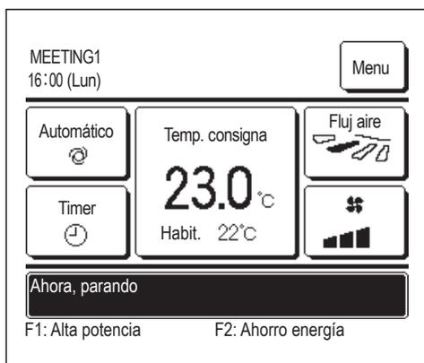
Si la configuración del sensor control está deshabilitada, aparece la temperatura de habitación ○°C.
