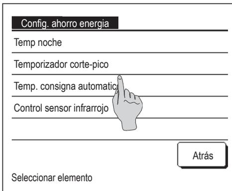
1 Toque el botón **Menu** en la pantalla SUPERIOR y seleccione **Config. ahorro energia**. Aparece la pantalla del menú de configuración del modo de ahorro de energía.
