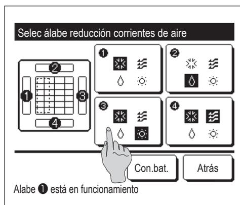
3 Seleccione el número de salida de aire para configurar la anti corriente.
