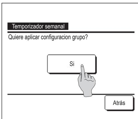
**13** Se abre una pantalla que muestra la configuración de grupo. Toque el botón **Si** y guarde la configuración.
