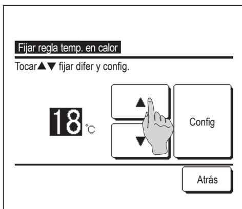
**6** Defina la temperatura interior para pasar al modo de calefacción después de configurar “Fijar regla en calor”.
