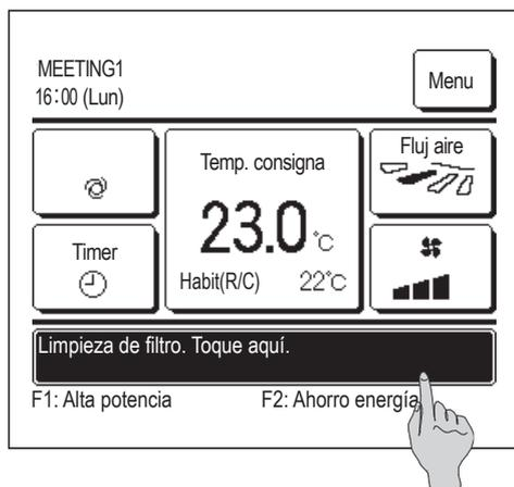
1 Pulse la pantalla del mensaje en la pantalla SUPERIOR.
