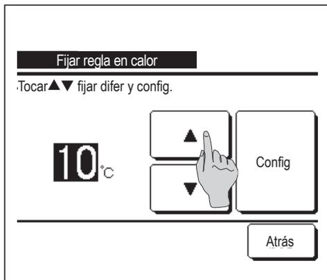
**4** Defina la temperatura exterior para “Fijar regla en calor”.
