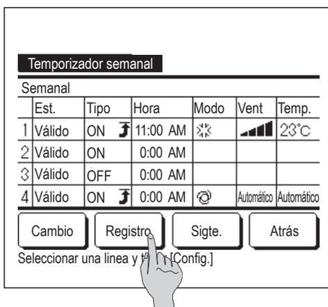
**12** Se abre una pantalla que muestra la configuración. Pulse el botón **Registro** para registrar la configuración.
