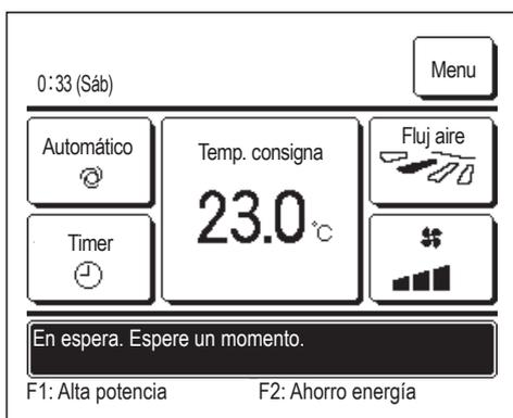
El mensaje “En espera. Espere un momento.” puede aparecer (un máximo de 30 minutos) en el M/D durante la primera operación posterior a una interrupción del suministro eléctrico o a una pérdida de energía. Esto no indica ningún fallo: se trata de que el control de protección de aceite de la máquina se activa para proteger el compresor. Espere hasta que desaparezca el mensaje “En espera. Espere un momento.”
