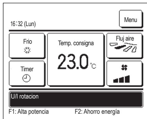
Si se habilitan operaciones de rotación, reserva de capacidad o reserva de fallos durante la instalación, en la pantalla de mensajes aparecerá un mensaje indicando la operación que está configurada y en marcha en ese momento.
