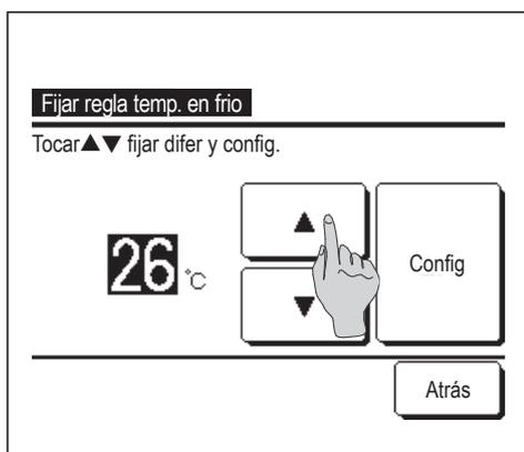
**5** Defina la temperatura interior para pasar al modo de refrigeración después de configurar “Fijar regla en frío”.
