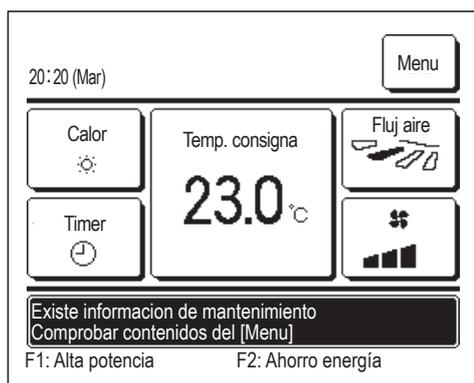
Para notificar información de mantenimiento relacionada con el producto, puede aparecer el mensaje “Existe información de mantenimiento. Comprobar contenidos del [Menú].” en la pantalla de mensajes.
