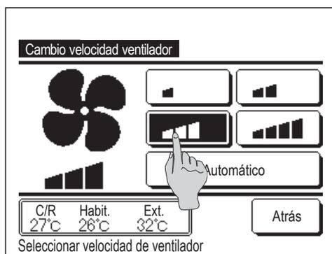
1 Toque el botón **Cambio velocidad ventilador** en la pantalla SUPERIOR.
