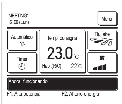
Cuando la configuración del sensor de control esté habilitada, aparecerá la temperatura de la habitación  $\text{°C}$  (M/D) (consulte en el manual de instalación la forma de llevar a cabo estas configuraciones).
