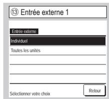
Sélectionner la plage d'application de l'entrée externe reçue par le biais du connecteur CNT d'une seule unité ou de plusieurs unités raccordées à ce système.
