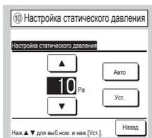
Статическое давление регулируется в случае подсоединения к UI типа воздуховода с функцией регулирования внешнего статического давления. Выберите внешнее статическое давление и нажмите кнопку  .
