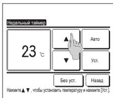
9 Выберите нужную температуру (с шагом 1 °C) с помощью кнопок  . Либо нажмите кнопку  **Авто** и выберите автоматическую установку температуры.
