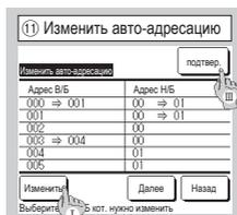
В моделях Multi series (KX) адреса В/В, зарегистрированные методом настройки авто-адреса, могут быть изменены с помощью этой функции. Данная функция позволяет изменить адрес OU для каждого внутреннего агрегата. Выберите внутренний агрегат и
