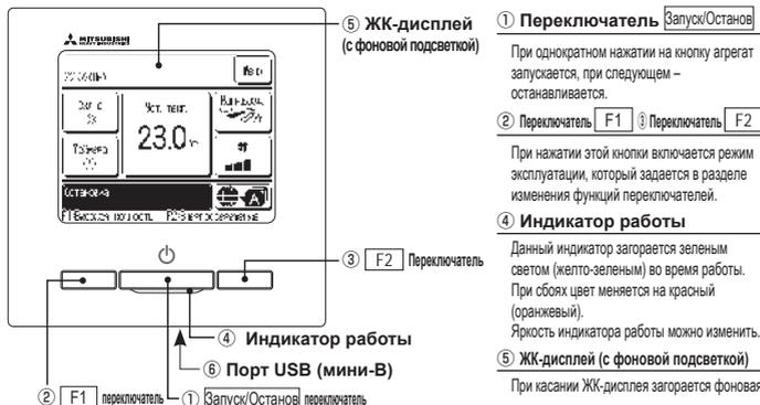
Система с сенсорной панелью, срабатывающая при касании пальцем ЖК-дисплея, применяется для любых действий, кроме ① Запуска/Останов, ② переключатели F1 ③ F2.
