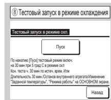
Данная функция может использоваться при условии отключения режима охлаждения. Если комнатная температура слишком низкая для запуска теста охлаждения, то режим работает в течение 30 минут, понижая заданную температуру до 5°C.
