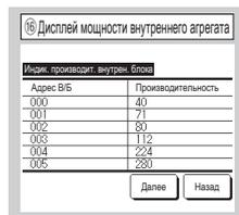
Отображаются характеристики В/Б, подключенных к ПДУ. В случае подключения семи и более агрегатов нажмите кнопку **Далее**, чтобы просмотреть все агрегаты. Эти позиции могут не отображаться в зависимости от комбинации В/Б и Н/Б.
