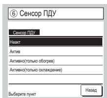
Можно изменить температурный датчик рециркуляционного воздуха главного В/Б на стороне ПДУ.
