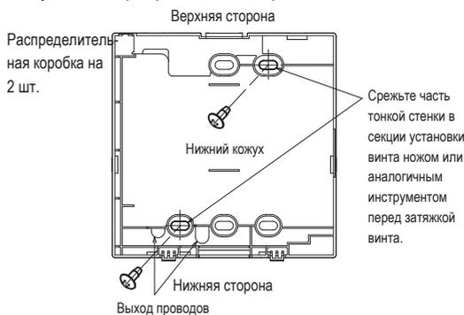
③ Подсоедините провода от клемм X и Y ПДУ к клеммам X и Y внутреннего агрегата. Провода ПДУ (X, Y) не имеют полярности. Закрепите проводку так, чтобы провода были проложены вокруг винтов клемм на верхнем кожухе ПДУ.
