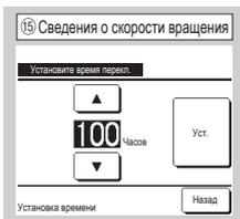
В функции чередования В/Б задается таймер для замены работы двух внутренних агрегатов.
