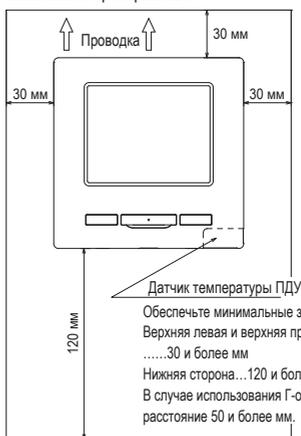
Обеспечьте минимальные зазоры для демонтажа кожуха.
