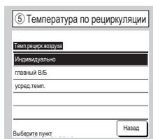
Правило Thermo применяется на основании температуры, выявленной температурным датчиком рециркуляционного воздуха, установленным на внутреннем агрегате (В/Б).
