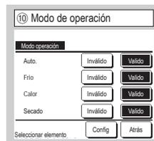
Valido o Inválido pueden configurarse para cada modo de operación. Si se deshabilita el modo de calefacción o refrigeración, también se desactiva el modo automático.
