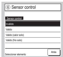
Se puede cambiar el sensor de temperatura del aire de retorno de la unidad principal de U/I en el lateral del M/D.
