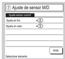
Se puede ajustar la temperatura de detección del sensor del M/D.
