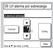
La señal de alarma por sobrecarga se transmite desde la salida externa (CNT-5) cuando la diferencia entre la temperatura ambiente y la temperatura especificada alcanza un determinado valor después de 30 minutos de funcionamiento.
