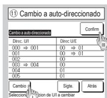
En el caso de modelos de la serie Multi (KX), esta función permite cambiar las direcciones de unidades interiores registradas con el método de configuración auto-direccionado. Esta función cambia la dirección de la U/E para cada U/I. Seleccione una U/I y,
