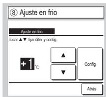
La temperatura de detección del sensor del M/D durante la operación de refrigeración puede corregirse. Configure el valor dentro del intervalo de -3 a +3.
