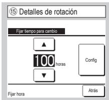
En la función U/I rotación, se configura el temporizador que inter-cambia el funcionamiento de 2 unidades interiores. El temporizador se puede configurar de diez en diez horas en un intervalo entre las 1 y las 990 horas.
