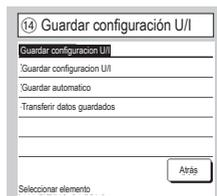
**Guardar configuración U/I** Los valores de configuración de todas las unidades interiores conectadas al M/D se guardan en el M/D.
