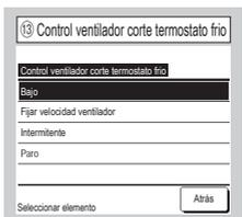
Configura la velocidad del ventilador cuando se apaga el termostato en frío.
