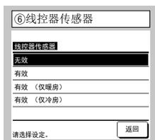
您可以将室内机主机回气温度传感器更改到线控器侧。
