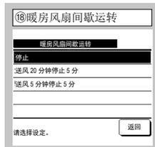
停止后，在剩余送风运转后选择送风控制，并在暖房模式中选择温控器关闭。
