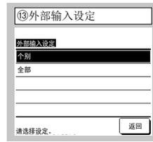
设定范围，以将通过其中一个室内机的 CNT 接收的外部输入设定应用于一个系统中连接的多室内机
