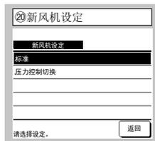
将室外空调设备连接到多 (KX) 系统时，设定控制压力。
