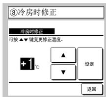
可以修正冷房运转过程中的线控器传感器检测温度。在 -3 至 +3 的范围内设定值。
