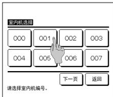
1 当两个或多个室内机连接到线控器时，显示室内机列表。点按要设定的室内机。
