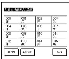
1 显示每个防直吹功能的室内机编号和开/关状态以允许防直吹功能的开/关设定。按开会关闭防直吹功能，而按关会将其打开。
