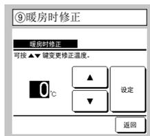
可以修正暖房运转过程中的线控器传感器检测温度。在 -3 至 +3 的范围内设定值。
