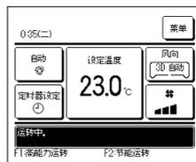
5 当启用了 3D 自动流运转时，**风向切换** 按钮上将显示“3D 自动”，如左图所示。
