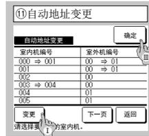
如果是多系列 (KX) 型号，可以使用该功能更改通过自动地址设定方法登记的室内机编号。该功能可更改每个室内机的室外机编号。选择室内机，**I** 选择室内机并按 **变更** 按钮时，显示屏更改为“自动地址变更”屏幕 **⑫**。
