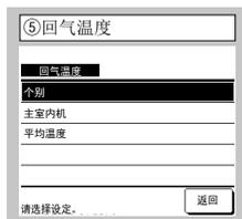
根据通过室内机的回气温度传感器检测到的温度应用温控器判定。
