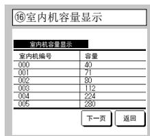
显示与线控器连接的室内机的容量。
