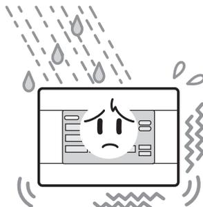
L'installation dans un endroit exposé à l'humidité, aux éclaboussures ou à d'importantes vibrations risque de provoquer des dysfonctionnements.
