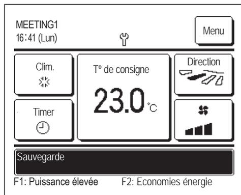
Si le message "Sauvegarde" est affiché, contactez le revendeur/le SAV grâce aux coordonnées fournies (☞ page 70) afin qu'une inspection soit menée au plus vite.
