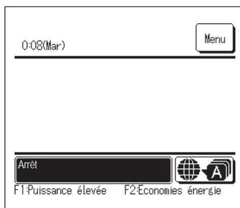
Quand l'appareil s'arrête, toutes les touches de fonctionnement de l'écran s'éteignent. Quand la durée de maintien du rétro-éclairage (☞ page 38) est atteinte, le rétro-éclairage s'éteint.
