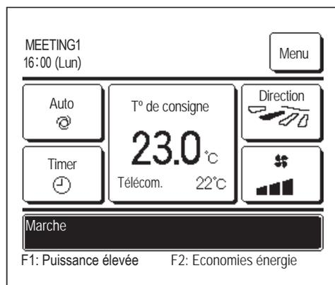
Lorsque le réglage du capteur de la télécommande est désactivé, la température de la pièce ○ °C est affichée.
