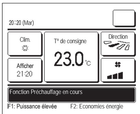
Si le chauffage est activé par une Réglage ON par décompte (page 41) ou par une Réglage ON par définition d'une heure (page 43), l'unité démarrera entre 50 et 60 minutes avant l'heure prévue, en fonction du dernier chauffage effectué, afin que la pièce soit préchauffée à un niveau proche de la température de consigne avant que le mode chauffage ne soit activé.
