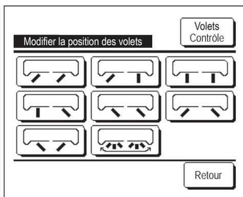
**4** Appuyer sur l'orientation souhaitée. Après avoir sélectionné l'orientation des volets, l'écran de sélection des volets s'affiche à nouveau. (➡ 1)
