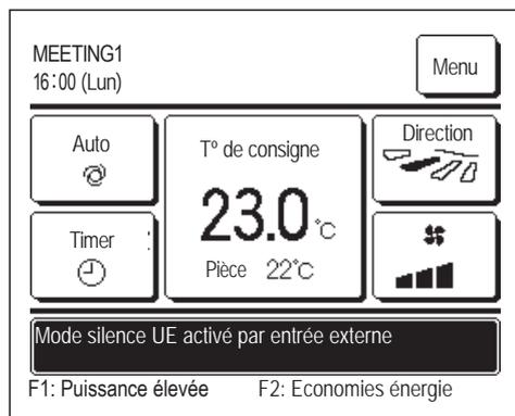
Lorsque le message "Mode silence UE activé par entrée externe" est affiché, l'unité fonctionne dans les mêmes conditions que lorsque la programmation du mode silencieux est mise en place (☞ page 66) via la télécommande.
