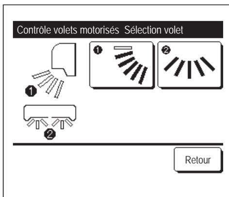
Sur un FDK doté d'un volet gauche/droit, sélectionner le volet supérieur/inférieur ou gauche/droit.
