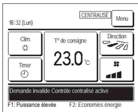
Ce message n'indique pas une défaillance. Il indique que l'unité est contrôlée par un dispositif de contrôle centralisé.
