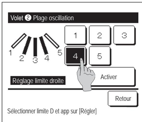
9 Sélectionner l'une des limites de position latérales à droite de **1** à **5** pour régler la plage de mouvement du volet.
