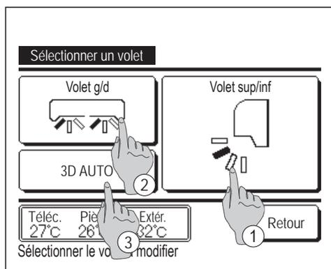
**3** Lorsqu'un ou plusieurs FDK dotés d'un volet gauche/droit sont raccordés, l'écran de sélection des volets s'affiche. Sélectionner l'orientation souhaitée des volets.
