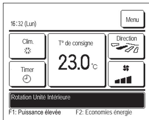
Lorsque le mode Rotation, Compensation de puissance ou Compensation d'erreur est activé au cours de l'installation, un message indiquant le mode actuellement activé s'affiche à l'emplacement des messages.
