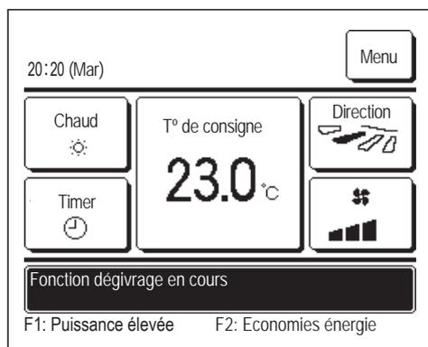
Si du givre se forme sur l'unité extérieure, ses performances de chauffage se dégradent. L'unité passe alors automatiquement en mode dégivrage, et l'unité intérieure ne souffle plus d'air chaud.
