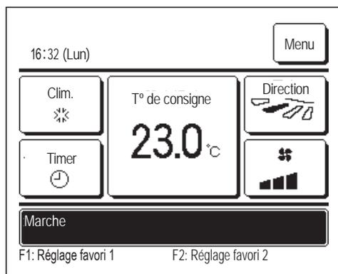
**1** Appuyer sur l'interrupteur **F1** (**F2**), permet d'activer les réglages mode de fonctionnement, température de consigne, vitesse de ventilation et orientation des volets enregistrés dans Réglage favori 1 et Réglage favori 2.
