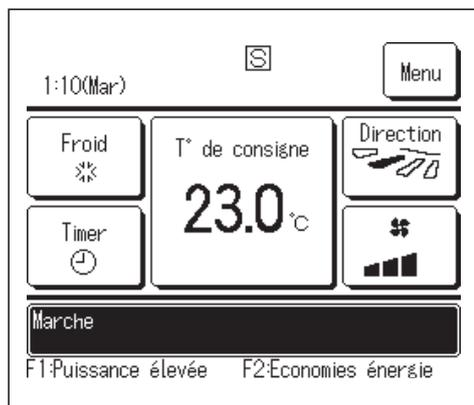
Si une unité intérieure est contrôlée à l'aide de 2 télécommandes, les paramètres suivants ne peuvent pas être réglés via la télécommande secondaire. La télécommande principale devra être utilisée.
