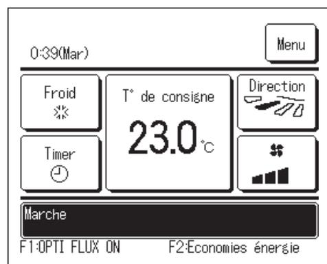
**1** Appuyez sur la touche **F1** (**F2**). L'anti courant d'air est activé (fonctionne). « OPTI FLUX ON » s'affiche dans la zone d'affichage de la fonction de la touche **F1** (**F2**).
