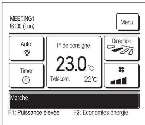
Lorsque le réglage du capteur de la télécommande est activé, la température de la pièce (TD) ○ °C s'affiche (voir le manuel d'installation pour savoir comment effectuer ces réglages).
