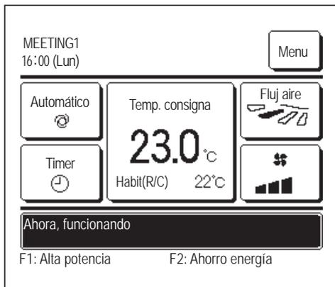
Cuando la configuración del sensor de control esté habilitada, aparecerá la temperatura de la habitación ○°C (M/D) (consulte en el manual de instalación la forma de llevar a cabo estas configuraciones).
