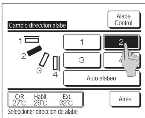
2 Cuando aparezca la pantalla de cambio de dirección del álabes, pulse el botón de la dirección deseada.
