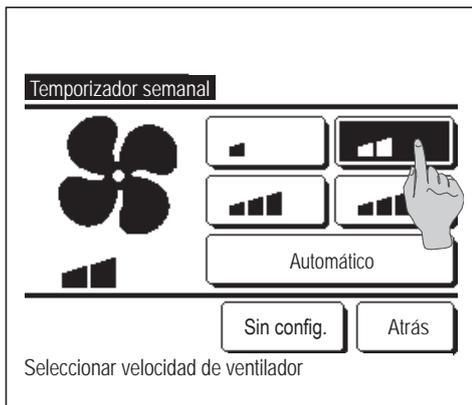
**10** Seleccione la velocidad de ventilador deseada.
