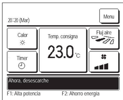
Cuando se forma hielo en la U/E, el rendimiento de la calefacción disminuye. Esto provocará que la unidad active automáticamente la operación de desescarche, por lo que el aire caliente dejará de salir de la U/I.
