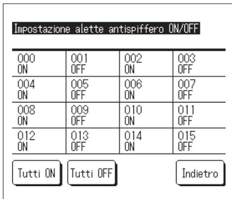
1 Il numero di unità interna e lo stato ON/OFF di ciascuna funzione anti spiffero sono visualizzati per consentire la selezione dell'impostazione ON/OFF per la funzione anti spiffero. La funzione anti spiffero si disattiva toccando ON e si attiva toccando OFF.
