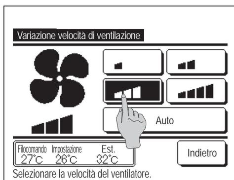
2 Quando viene visualizzata la schermata Variazione velocità di ventilazione, premere il pulsante corrispondente alla velocità di ventilazione desiderata.
