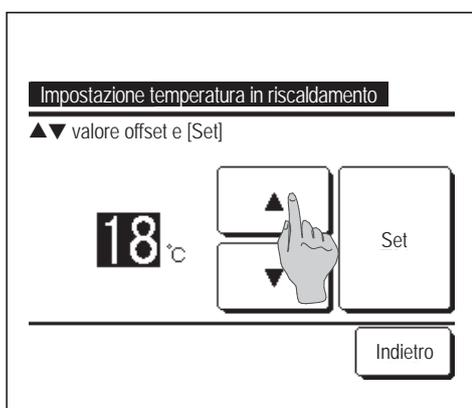
**6** Impostazione della temperatura interna per l'avvio del funzionamento in riscaldamento, dopo la "Selezione temperatura in Riscaldamento".
