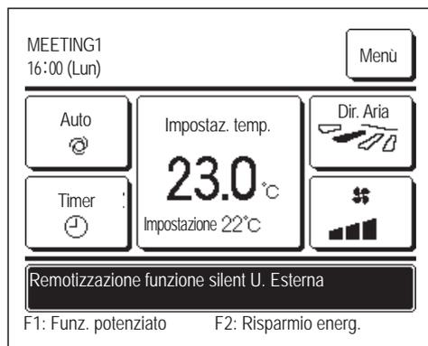
Quando viene visualizzato il messaggio “Remotizzazione funzione silent U. Esterna”, l'operazione eseguita sarà identica a quella funzione Cont. mod. silenziosa (➔ pagina 66) eseguita dal Filocomando.
