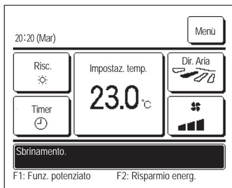
Quando si forma brina nella U/E, le prestazioni di riscaldamento si riducono. Questo causa il passaggio automatico dell'unità allo sbrinamento, quindi l'aria calda smette di fuoriuscire dall'U/I. Nello schermo messaggi compare il messaggio “Sbrinamento”. Dopo il completamento del funzionamento in sbrinamento, il messaggio “Sbrinamento” scompare, e l'unità torna al suo normale funzionamento in riscaldamento.
