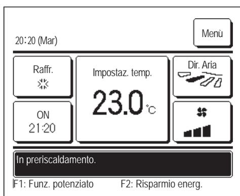
Quando si seleziona l'attivazione del preriscaldamento mediante le schermate Impostare l'ora di avvio (ON) (☞ pagina 41) o Impost. l'intervallo di tempo per Timer ON (☞ pagina 43), il funzionamento inizia da 50 a 60 minuti prima, valore che viene previsto sulla base della precedente fase di preriscaldamento, in modo che l'ambiente sia vicina alla temp impostata per il momento in cui raggiunge l'ora di inizio dell'operazione.
