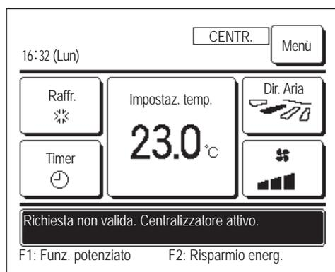
Questo non indica un guasto; il messaggio indica che l'unità è controllata per mezzo di un dispositivo di controllo centrale.
