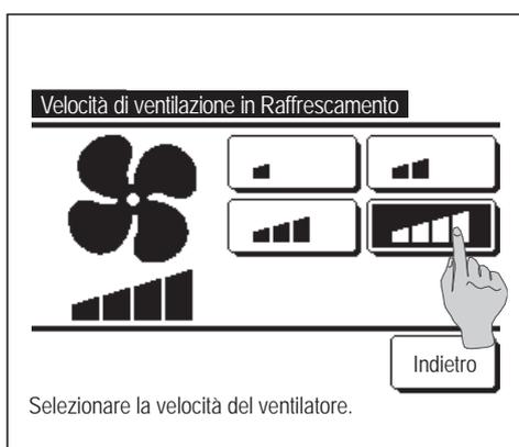
**7** Impostazione della Velocità di ventilazione in modo Raffr.
