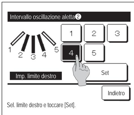
9 Selezionare una delle posizioni limite destra da 1 a 5 per l'intervallo di oscillazione dell'aletta.
