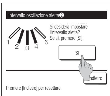
10 Visualizzazione della schermata Riconoscimento per l'intervallo di oscillazione dell'aletta.
