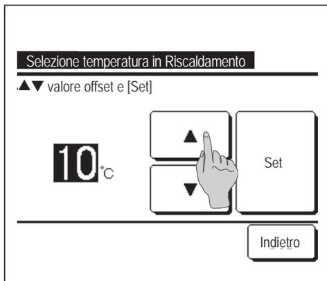
**4** Impostazione della temperatura esterna per "Selezione temperatura in Riscaldamento".
