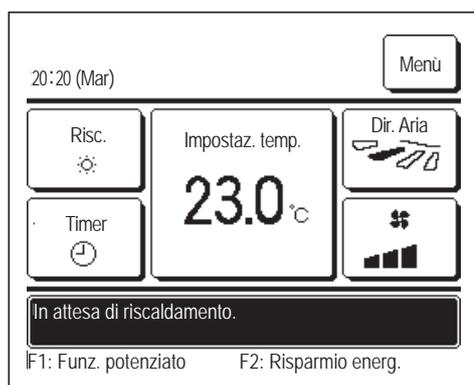
Per impedire che la fuoriuscita di aria fredda soffi dalla U/I all'inizio di un'operazione di riscaldamento, l'unità arresta il ventilatore e mostra il messaggio “In attesa di riscaldamento”.
