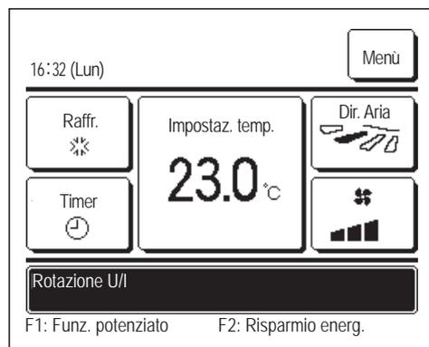
Quando le operazioni di rotazione, ripristino potenza o ripristino guasti sono attivate durante l'installazione, nello schermo messaggi compare un messaggio che indica che l'operazione impostata e in corso. Fare riferimento al Manuale di installazione per le modalità di definizione delle impostazioni.
