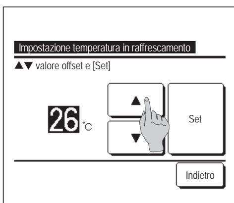
**5** Impostazione della temperatura interna per l'avvio del funzionamento in raffreddamento, dopo la "Selezione temperatura in Raffrescamento".
