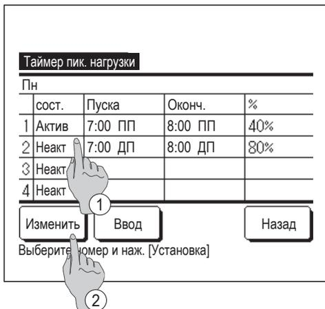
**5** Открывается экран проверки содержания текущей установки.
