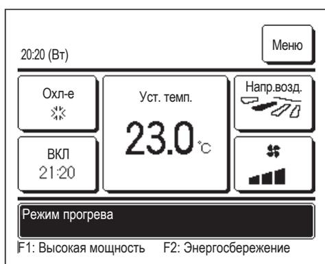
В случае выбора включения прогрева с помощью таймера ВКЛ через промежуток времени (☞ стр. 41) или таймера ВКЛ по часам (☞ стр. 43) работа начнется на 50 - 60 минут раньше, что прогнозируется, исходя из предыдущей операции прогрева, поэтому к моменту достижения времени начала работы температура в помещении будет приближаться к заданной температуре.
