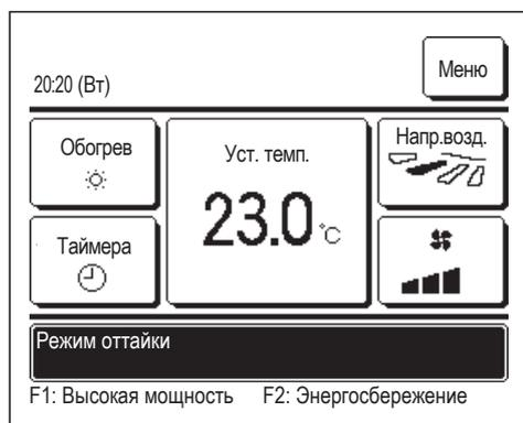
В случае образования инея на наружном агрегате эффективность обогрева снижается. Это приведет к автоматическому переключению устройства на режим оттаивания, и горячий воздух перестанет выдвигаться из ИО.
