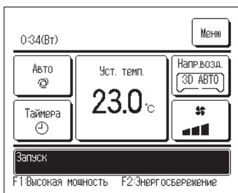
**5** При включении функции 3D АВТО на кнопке **Изменить направление жалюзи** отображается «3D АВТО», как показано слева.
