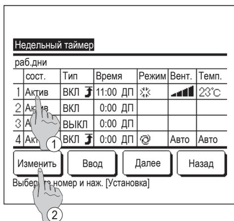
6 Отобразится экран установки таймера.
