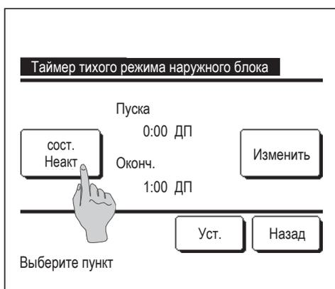
2 Открывается экран настройки таймера тихого режима наружного блока.
