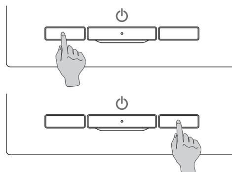
Изменение функции переключателя **F1** или **F2** может выполняться с помощью опции «Настройка функции F1/F2» ( стр. 65).
