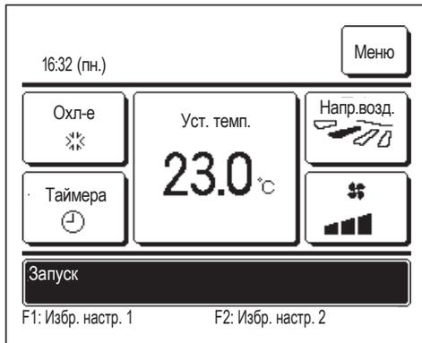
**1** При нажатии на переключатель **F1** (**F2**) режим работы, заданная температура, скорость вентилятора, направление жалюзи, зарегистрированные в «Избр. настр. 1» и «Избр. настр. 2» активированы.
