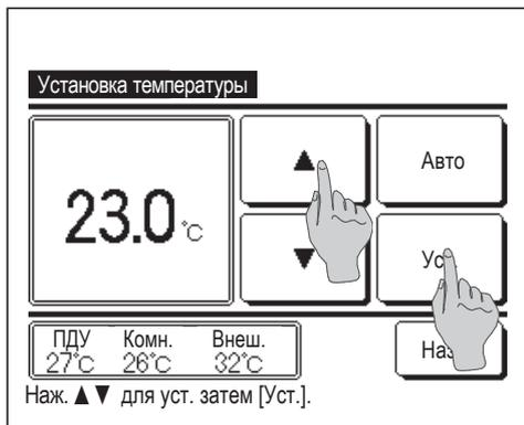
2 Когда отобразится экран Установка температуры, выберите нужную температуру кнопками .
