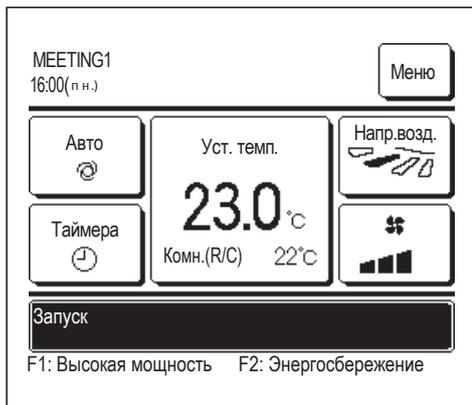
Если датчик ПДУ активирован, отображается температура в помещении (ПДУ) °C (порядок выполнения этих настроек см. в руководстве по установке).
