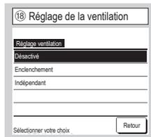
Configurer ceci lorsqu'un appareil de ventilation est raccordé.
