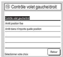
**Arrêt position fixe** Le volet gauche/droite peuvent être réglé pour s'arrêter en huit positions différentes.
