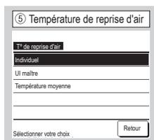
La loi thermique s'applique en fonction de la température détectée par la sonde de reprise d'air de l'UI. Quand plusieurs unités sont raccordées à une seule télécommande, il est possible de choisir la température de reprise d'air appliquée à la loi thermique.
