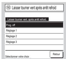
Sélectionner la durée de fonctionnement résiduel de la ventilation en régulation et après l'arrêt en mode froid.
