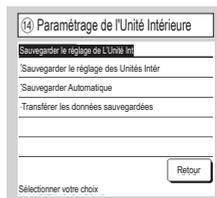
**[Sauvegarder le réglage des Unités Intér.]** Tous les paramètres des UI raccordées à une télécommande sont enregistrés dans la télécommande.
