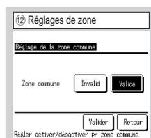
Régler lors de l'exécution du contrôle de zone. Définir s'il existe une zone commune ou non. (Valide : Présente, Invalide : Non présente) Une zone commune est une zone où aucun clapet n'est installé.
