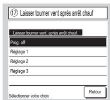
Sélectionner la durée de fonctionnement résiduel de la ventilation en régulation et après l'arrêt en mode chauffage.
