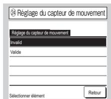
Sélectionnez  /  pour le capteur de mouvement de l'unité intérieure connecté à la télécommande.
