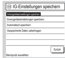
**Innengeräteinstellungen speichern** Alle Einstellungen des mit der Fernbedienung verbundenen Innengeräts werden in der Fernbedienung gespeichert.
