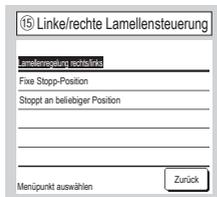
**Fixe Stopp-Position** Die linke/rechte Lamelle kann so eingestellt werden, dass sie in einer von 8 Positionen stoppt.
