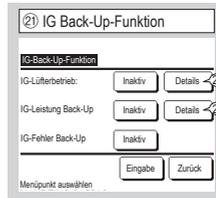
Wenn 2 Innengeräte (2 Gerätegruppen) mit einer Fernbedienung verbunden sind, kann ein Back-Up für diese Geräte durchgeführt werden.
