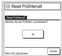
Beim Zurücksetzen des Prüfintervalls wird der Stundenzähler zurückgesetzt.
