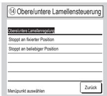
**Stoppt an fixierter Position** Die obere/untere Lamelle kann so eingestellt werden, dass sie in einer von 4 Positionen stoppt.
