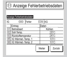
Datum und Uhrzeit des Fehlers, IG-Adresse und Fehlercode werden angezeigt.
