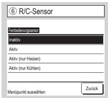
Der Rücklufttemperatursensor kann vom IG-Master-Gerät auf die Fernbedienung umgeschaltet werden.
