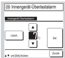
Wenn die Raumtemperatur 30 Minuten nach Betriebsstart um ein bestimmtes Maß von der Solltemperatur abweicht, wird vom externen Ausgang (CNT-5) ein Überlast-Alarmsignal gesendet.
