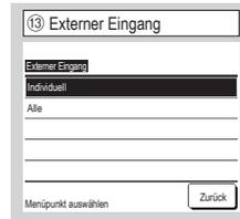
Den Bereich für den externen Eingang einstellen, der über den externen Ausgang (CNT) eines einzelnen IG oder mehrerer Innengeräte, die in einem System miteinander verbunden sind, empfangen wird.
