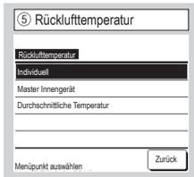
Die Thermo-Steuerung erfolgt auf der Basis der Temperatur, die vom Rückluft-Temperatursensor des IG gemessen wird.
