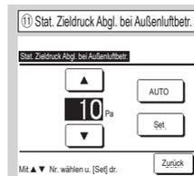
Diese Funktion kann ausgeführt werden, wenn ein Innengerät mit Kanal und Einstellfunktion für den externen statischen Druck angeschlossen ist. Externen statischen Druck auswählen und  drücken.
