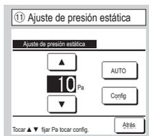
Esta opción se puede utilizar si se conecta una unidad interior de tipo conducto con la función de ajuste de presión estática externa. Seleccione la presión estática externa y pulse el botón .
