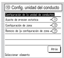
**Ajuste de presión estática** : Lleva a cabo el ajuste de presión estática externa de la unidad del conducto.
