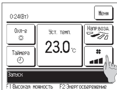
1 Нажмите кнопку **Изменить скорость вентилятора** на ОСНОВНОМ экране.
