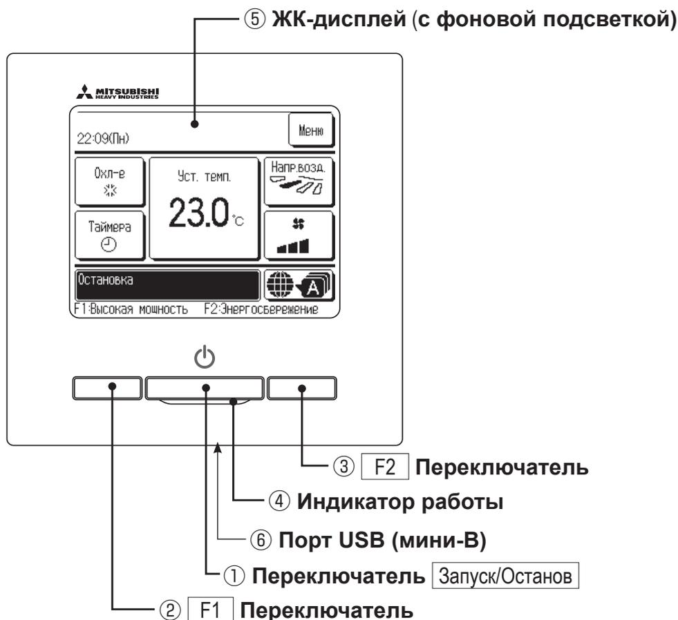
Система с сенсорной панелью, срабатывающая при касании пальцем ЖК-дисплея, применяется для любых действий, кроме ① Run/Stop (пуск/стоп), ② переключатели F1 ③ F2.
