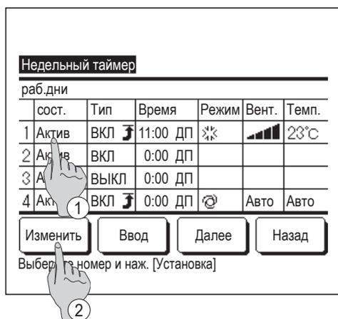
6 Отобразится экран установки таймера.
