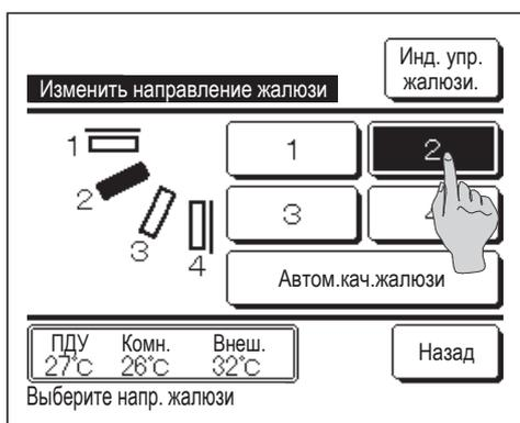
**2** Когда отобразится экран «Изменить направление жалюзи», нажмите кнопку нужного направления жалюзи.
