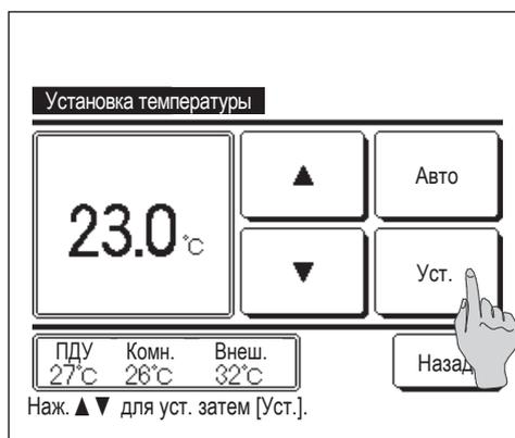
4 Когда на экране настроек для каждого пункта отображается кнопка **Уст.**, при нажатии на нее настройка подтверждается.
