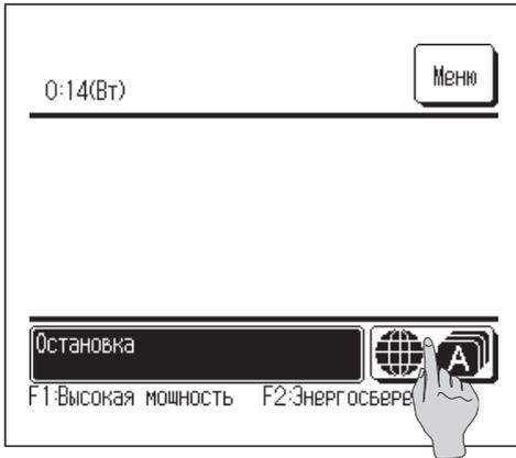
1 Нажмите на кнопку
