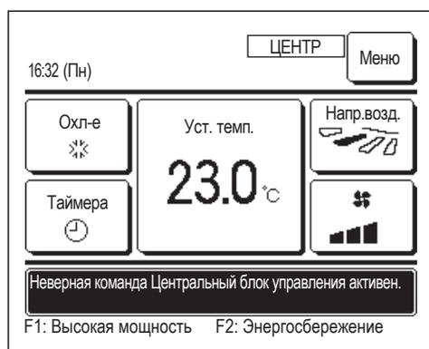
Сообщение не указывает на неисправность, а указывает на то, что агрегат управляется с помощью центрального устройства управления.
