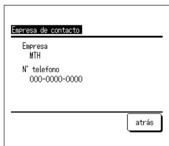
3. Se muestra la pantalla [Contacto de la empresa] (Nombre de la empresa y número de teléfono) Si se introduce por adelantado, puede visualizarse.
