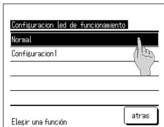
1. Cuando pulse la [Configuración del indicador de funcionamiento] en la pantalla del menú [configuraciones del administrador], se mostrará la pantalla del menú [Configuración del indicador de funcionamiento].
