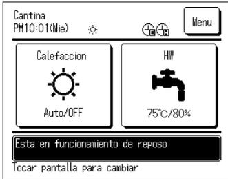
Cuando se controla un equipo bomba de calor con dos mandos a distancia, las siguientes configuraciones no pueden realizarse con el mando a distancia secundario. Configúrelas con el mando a distancia principal. En caso de realizar la configuración con el mando a distancia secundario, se mostrará el icono en la pantalla SUPERIOR.
