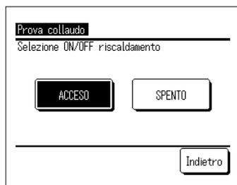
2. Premendo **ON**, si avvia il riscaldamento. Premendo **OFF**, si ferma il riscaldamento.
