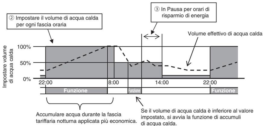
Impostazione del funzionamento del serbatoio di accumulo di acqua calda (Fare riferimento alla modalità di impostazione a pag. 20)
