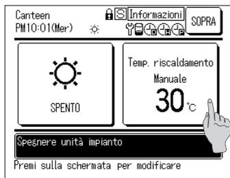
1. Premere il pulsante **Impostazione temperatura di riscaldamento** sulla schermata principale di Riscaldamento. Si visualizza la schermata di impostazione della temperatura di riscaldamento.
