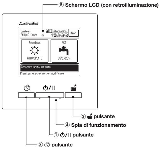
Il sistema touch screen, che funziona toccando lo schermo LCD con un dito, si utilizza per tutte le operazioni, ad eccezione dei pulsanti ①Avvio/Pausa, ②Programmazione e ③Riempimento.
