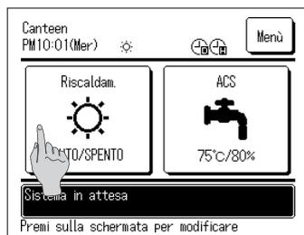
1. Premere il pulsante **Riscaldamento ON/OFF** sulla schermata principale del Riscaldamento. Si visualizza la schermata di Riscaldamento ON/OFF.
