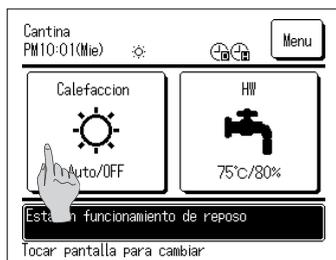
1. Pulse el botón **Calefacción ENCENDIDA/APAGADA** en la pantalla SUPERIOR de calefacción. Se muestra la pantalla calefacción ENCEDIDA/APAGADA.
