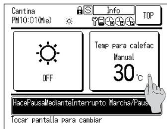
1. Pulse el botón **Temperatura de calefacción establecida** en la pantalla SUPERIOR de calefacción. Se muestra la pantalla SUPERIOR de temperatura de calefacción establecida.
