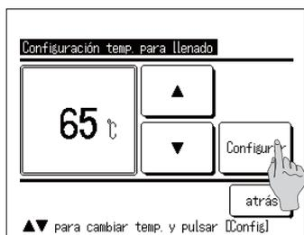
4. En la pantalla de configuración de cada elemento, si está el botón **Configurar**, el contenido de configuración puede confirmarse pulsando el botón **Configurar**.
