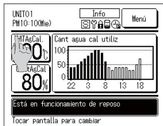
1. Pulse el botón **Temperatura del agua caliente** en la pantalla SUPERIOR de agua caliente.
