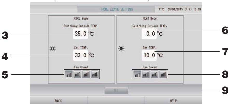
3. Нажмите **Switching Outside TEMP. (°C) (Переключение наружной ТЕМПЕРАТУРЫ)** в **COOL Mode (режиме ОХЛАЖДЕНИЕ)** настройки отпуска.
