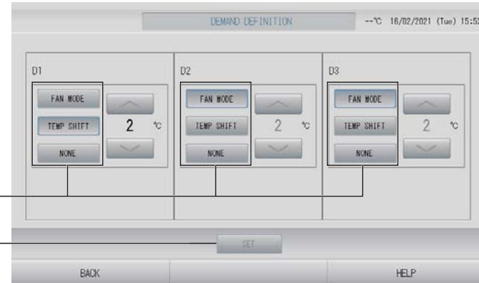
3. Выберите FAN MODE (РЕЖИМ ВЕНТИЛЯЦИИ), TEMP SHIFT (СМЕЩЕНИЕ ТЕМПЕРАТУРЫ) ИЛИ NONE (НЕТ).
