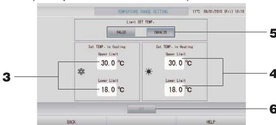
3. Нажмите Upper/Lower limit (°C) (Верхний/Нижний предел) настройки SET TEMP. (ЗАДАНИЕ ТЕМПЕРАТУРЫ) во время операции Cooling (Охлаждение). Выберите температуру нажатием кнопки ☎ или ☎ и кнопки OK.
