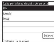
**Alta:** stesso livello di concentrazione al rilevamento di una perdita di refrigerante
