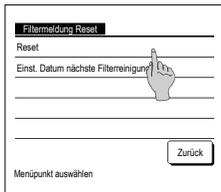
2 Filterm. Reset wird auf dem Menü-Bildschirm angezeigt.
