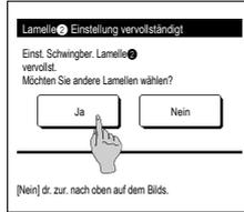
**11** Die Bestätigungsanzeige für die Beendigung der Einstellungen erscheint. Zum Ändern weiterer Lamellenschwingbereiche die Schaltfläche **Ja** drücken. (#=3) Um die Einstellung zu beenden, die Schaltfläche **Nein** drücken. Die Anfangsanzeige erscheint wieder.
