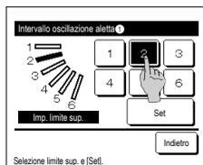
4 Selezionare una delle posizioni limite superiori da 1 a 6 per l'intervallo di oscillazione dell'aletta.
