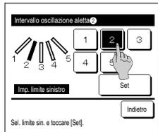
8 Selezionare una delle posizioni limite a sinistra da 1 a 5 per l'intervallo di oscillazione dell'aletta.
