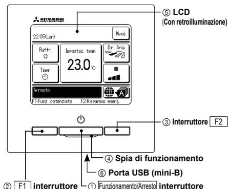
Il sistema Touch Panel, che viene attivato premendo con un dito lo schermo LCD, può essere utilizzato per qualsiasi operazione, tranne
