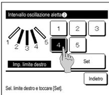
9 Selezionare una delle posizioni limite a destra da 1 a 5 per l'intervallo di oscillazione dell'aletta.
