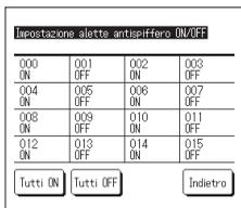
**1** Il numero di unità interna e lo stato ON/OFF di ciascuna funzione anti spiffero sono visualizzati per consentire la selezione dell'impostazione ON/OFF per la funzione anti spiffero. La funzione anti spiffero si disattiva toccando ON e si attiva toccando OFF. Se due o più unità interne dotate di funzione anti spiffero sono collegate al filocomando vengono visualizzate tali unità interne.
