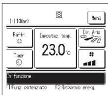
Se una Unità Interna viene controllata da 2 Filocomandi, non è possibile eseguire le seguenti impostazioni tramite il Filocomando Secondario. È necessario utilizzare il Filocomando Principale. Sullo schermo del Filocomando Secondario, viene visualizzata l'icona **S**.
