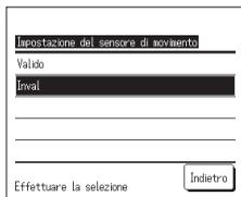
Se l'impostazione del sensore di movimento non è attivata anche se sono state effettuate le impostazioni descritte sopra, il controllo del sensore di movimento non verrà eseguito.
