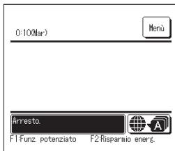
Quando l'operazione di arresto, tutti i pulsanti della schermata si disattivano. La retroilluminazione si spegne quando scade il tempo di illuminazione impostato.
