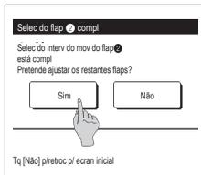
**11** É exibido o ecrã de confirmação para conclusão da configuração. Para alterar outros intervalos de movimento do deflector toque no botão **[ Sim ]** (≡=3) Para terminar a configuração, toque no botão **[ Não ]**. O monitor regressa ao ecrã superior.
