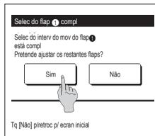
7 É exibido o ecrã de confirmação para conclusão da configuração. Para alterar outros intervalos de movimento do deflector toque no botão **Sim** (**433**). Para terminar a configuração, toque no botão **Não**. O monitor regressa ao ecrã superior.
