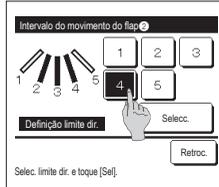
9 Seleccione uma das posições limite direitas de 1 para 5 para o intervalo de movimento do deflector. O intervalo de movimento entre as posições limite esquerdas e direitas é exibido a preto. Depois de seleccionar o intervalo, toque no botão **Selecc.**
