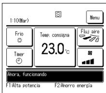
Si una unidad interior se controla con 2 M/D, algunas configuraciones no se pueden realizar con el M/D secundario. Hay que utilizar el M/D principal. La pantalla del M/D secundario muestra el icono **S**.
