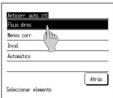
2 Seleccione el funcionamiento de cada salida de aire.
