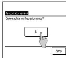
13 Se abre una pantalla que muestra la configuración de grupo. Toque el botón **Si** y guarde la configuración. Después de guardar, se abre una pantalla que muestra la configuración de un día de la semana. (≠#3)
