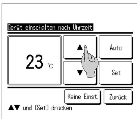
6 Wählen Sie die gewünschte Temperatur (bei 1 °C Intervallen) mit der Taste **▲** **▼**. Oder die Schaltfläche **Auto** drücken und „Autom. Temp. Einstellung“ wählen.
