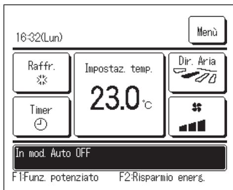
Viene visualizzato nell'area di visualizzazione dei messaggi quando viene abilitato il comando Auto OFF del controllo del sensore di movimento (➡ pagina 29) e viene eseguito il comando Auto OFF in stato di “attesa di funzionamento”.
