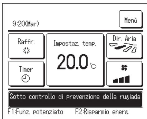
Se l'umidità intorno all'U/I è alta, la velocità di ventilazione e la direzione dell'aria potrebbero differire da quelle impostate al fine di prevenire la formazione di condensa sull'U/I e l'antispiffero potrebbe chiudersi. In tal caso, viene visualizzato il messaggio “Sotto controllo di prevenzione della rugiada.”. Quando l'umidità diminuisce, la velocità di ventilazione e la direzione dell'aria tornano normali e l'antispiffero si apre.
