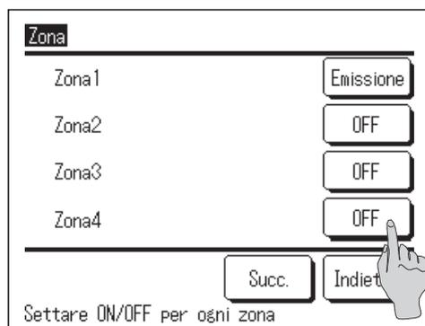
Imposta **ON** / **OFF** (APRI/CHIUDI) per ogni zona. A seconda del modello di U/I e delle impostazioni di installazione, verrà visualizzato il tasto **Succ.** e si potranno impostare fino a 8 zone.
