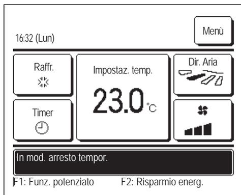
Questi messaggi verranno visualizzati quando l'unità viene azionata tramite il segnale di ingresso dell'U/I.
