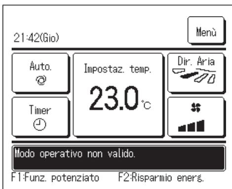
Se il condizionatore è un sistema di condizionamento per edifici di tipo multiplo, in alcuni casi le funzioni di raffreddamento/riscaldamento non possono essere combinate per ciascuna delle U/I connesse (tutte le U/I sarà nello stesso modo operativo a secondo del modello di U/E). Se si seleziona un modo operativo diverso da quello delle altre U/I, la ventilazione inizierà a funzionare e viene visualizzato il messaggio “Modo operativo non valido.”.
