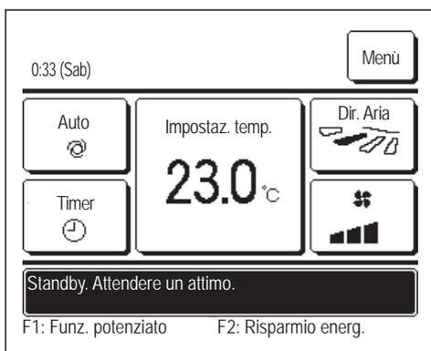
Il messaggio “Standby. Attendere un attimo” può comparire (massimo di 30 minuti) nel Filocomando durante la prima operazione dopo l'accensione di un interruttore o una perdita di potenza.
