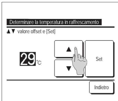
**3** Impostazione della temperatura esterna per “Selezione temperatura in Raffrescamento”.
