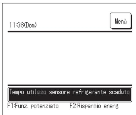
Il sensore del refrigerante è un componente che richiede una manutenzione regolare.
