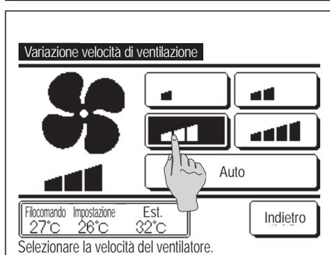
2 Quando viene visualizzata la schermata **Variazione velocità di ventilazione**, premere il pulsante corrispondente alla velocità di ventilazione desiderata. Dopo la selezione della velocità di ventilazione, il display ritorna alla schermata INIZIALE.
