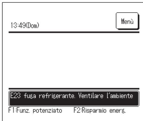
Questo messaggio viene visualizzato se il sensore del refrigerante rileva una perdita di refrigerante.
