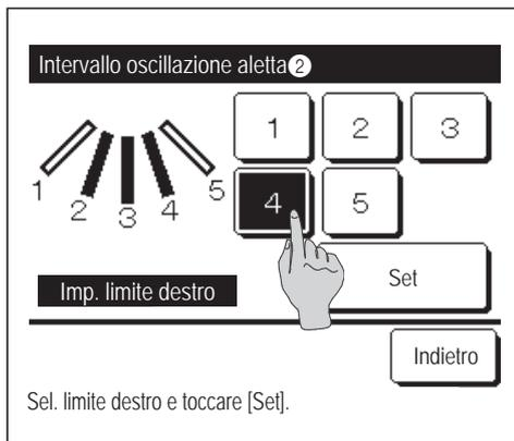
**9** Selezionare una delle posizioni limite destra da  a  per l'intervallo di oscillazione dell'aletta.
