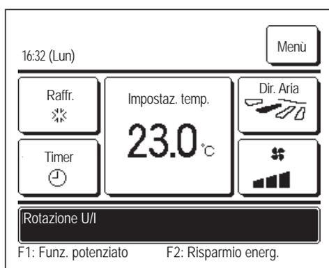
Quando le operazioni di rotazione, ripristino potenza o ripristino guasti sono attivate durante l'installazione, nello schermo messaggi compare un messaggio che indica che l'operazione impostata è in corso. Fare riferimento al Manuale di installazione per le modalità di definizione delle impostazioni.
