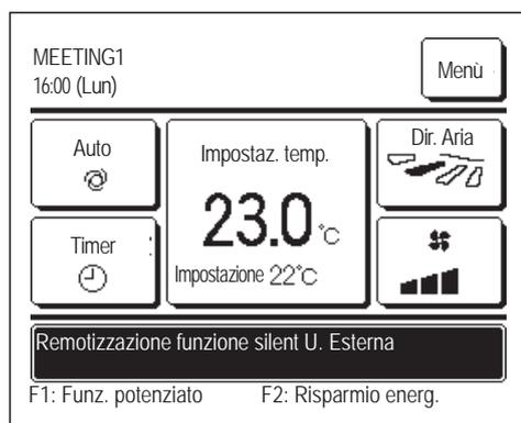
Quando viene visualizzato il messaggio “Remotizzazione funzione silent U. Esterna”, l'operazione eseguita sarà identica a quella funzione Cont. mod. silenziosa (☞ pagina 75) eseguita dal Filocomando.
