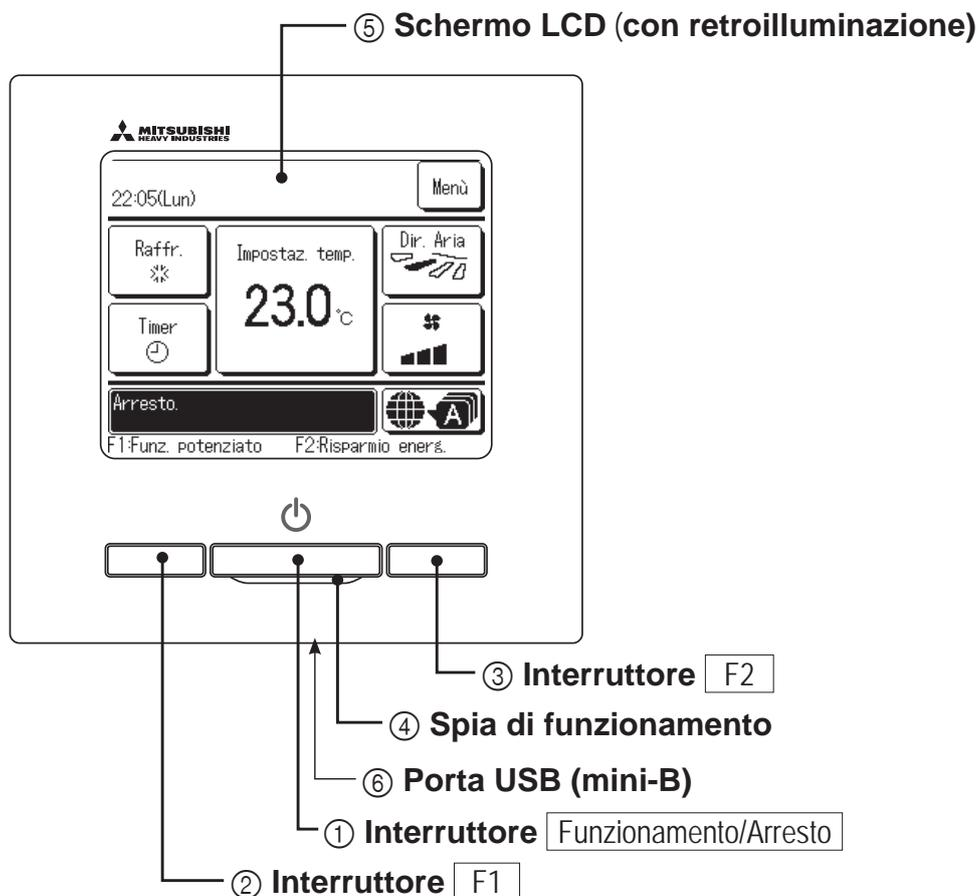
Il sistema Touch Panel, che viene attivato premendo con un dito lo schermo LCD, può essere utilizzato per qualsiasi operazione, tranne ① Funzionamento/Arresto, interruttori ② F1 ed ③ F2.
