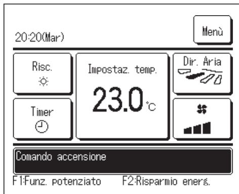
Viene visualizzato nell'area di visualizzazione dei messaggi quando viene abilitato il comando di alimentazione del controllo del sensore di movimento (➡ pagina 29) e viene eseguito il comando di alimentazione.
