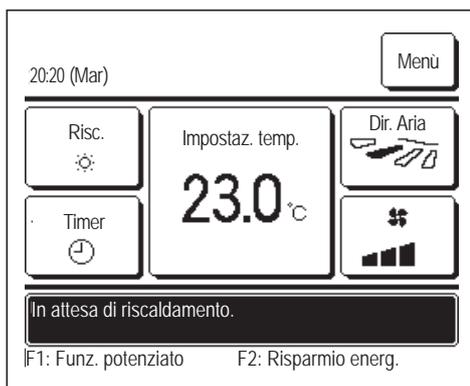
Per impedire che la fuoriuscita di aria fredda soffi dalla U/I all'inizio di un'operazione di riscaldamento, l'unità arresta il ventilatore e mostra il messaggio “In attesa di riscaldamento”. Quando l'unità è pronta a soffiare aria calda, il messaggio “In attesa di riscaldamento” scompare, e l'unità avvia il funzionamento in riscaldamento.
