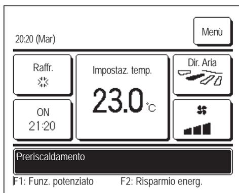
Quando si seleziona l'attivazione del preriscaldamento mediante le schermate Impostare l'ora di avvio (ON) (☞ pagina 44) o Impost. l'intervallo di tempo per Timer ON (☞ pagina 47), il funzionamento inizia da 50 a 60 minuti prima, valore che viene previsto sulla base della precedente fase di preriscaldamento, in modo che l'ambiente sia vicina alla temp. impostata per il momento in cui raggiunge l'ora di inizio dell'operazione.
