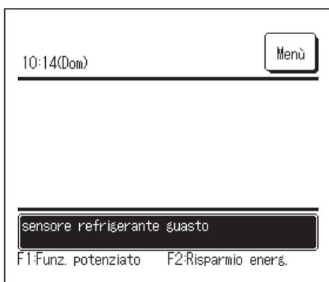
Questo messaggio viene visualizzato se il sensore del refrigerante non funziona.
