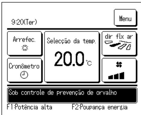
Se a humidade em torno da UI for elevada, a velocidade de ventilação e a direcção do flap podem diferir da velocidade de ventilação e da direcção do flap configuradas para evitar que se forme condensação na UI, e a função anti-vento pode fechar-se.
