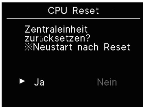
Setzen Sie den Mikrocomputer der angeschlossenen IUs & OUs zurück (auf den Status der Wiederherstellung der Stromversorgung)
