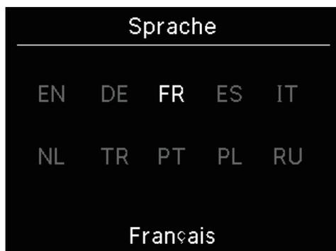
2 Der Bildschirm „Sprache“ wird angezeigt. Wählen Sie mit den Tasten  $\nabla$  /  $\wedge$  die Sprache, die auf der Fernsteuerung angezeigt werden soll, und tippen Sie auf die Taste .
