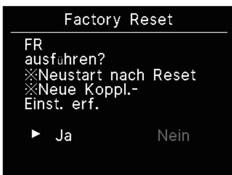
Setzen Sie die Einstellungen der angeschlossenen Fernbedienungen und IUs auf die ursprünglichen Einstellungen (Werkseinstellungen) zurück.
