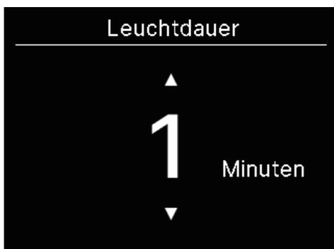
2 Der Bildschirm „Leuchtdauer“ wird angezeigt. Sie können die Beleuchtungsdauer der Hintergrundbeleuchtung mit den Tasten  $\nabla$  /  $\blacktriangle$  einstellen.
