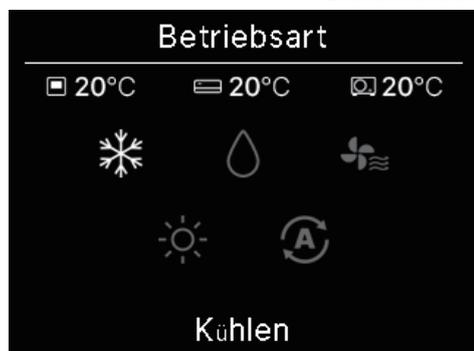
2 Der Bildschirm „Betriebsart“ wird angezeigt. Tippen Sie auf die Tasten  $\nabla$  /  $\blacktriangle$ , um den Betriebsmodus auszuwählen und tippen Sie auf die Taste , um zu entscheiden.
