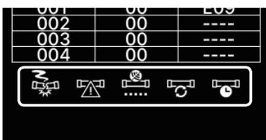
Wenn ein Fehler- oder Wartungscode im Zusammenhang mit dem Kühlmittelsensor leuchtet, werden Sie durch ein entsprechendes Symbol darauf hingewiesen.
