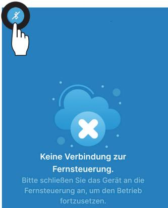
Wenn keine Verbindung zur Fernsteuerung besteht, wird ein Bildschirm wie links abgebildet angezeigt.
