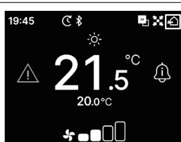
Das Symbol „Lüftung“ wird auf dem TOP-Bildschirm angezeigt, wenn die Belüftung eingeschaltet ist.
