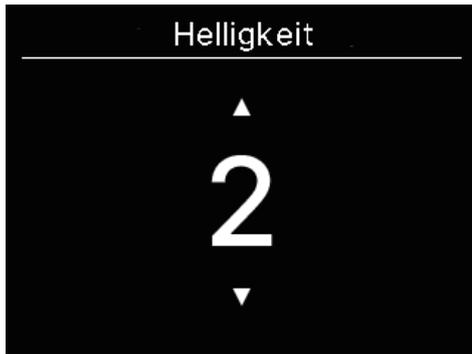
2 Der Bildschirm „Helligkeit“ wird angezeigt. Sie können die Helligkeit der Hintergrundbeleuchtung des Bildschirms auf eine gewünschte Stufe einstellen, indem Sie auf die Tasten  $\nabla$  /  $\blacktriangle$  tippen.
