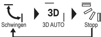
■ Wenn in einer gemischten Umgebung, die aus FDKs mit linker/rechter Klappe und IUs ohne linke/rechte Klappe besteht, mehrere IUs an die Fernsteuerung angeschlossen sind, werden die Modelle ohne linke/rechte Klappe bei Aktivierung der 3D-Automatik auf eine Klappenposition gesetzt, die vor dem Start der 3D-Automatik eingestellt wurde.
