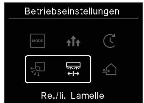
Wenn es keine IU mit linker/rechter Klappe gibt und wenn auch nur eine IU mit oberer/unterer Klappe angeschlossen ist, können Sie die obere/untere Klappe ändern (☞ Seite 20).
