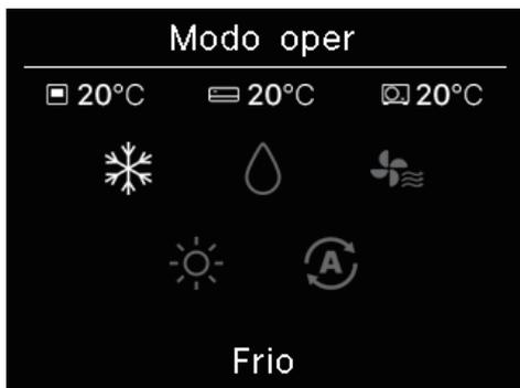
2 Se muestra la pantalla "Modo oper". Toque las teclas / para seleccionar el modo de operación, y toque la tecla para confirmar.
