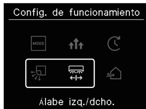
Cuando no hay ninguna unidad interior con álabes izquierdo/derecho, pero una unidad interior conectada tiene álabes superior/inferior, puede cambiarse entre los álabes superior/inferior.
