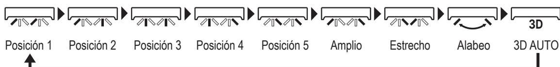
■ Si establece la configuración de los álabes en "Detener en cualquier posición" desde la aplicación (☞ Consulte el manual de la aplicación), toque las teclas  $\nabla$  /  $\blacktriangle$  para seleccionar "Alabeo" o "Paro" y cambiar la dirección de los álabes.
